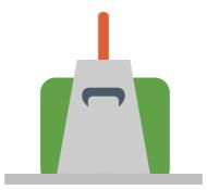
4) Limpe a placa de base se algum concreto tiver caído nela durante o preenchimento do molde (você pode usar a colher de pedreiro ou desempenadeira para isso). Em seguida, levante o molde cuidadosamente na direção vertical, puxando-o para cima pelas alças, em um tempo de 4 a 6 segundos.
