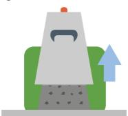
5) Com uma trena ou régua metálica, meça o abatimento do concreto, que é a diferença entre a altura do molde tronco-cônico e a altura média do corpo de prova desmoldado. Posicione a haste de adensamento sobre o tronco cônico para te ajudar com a referência da altura do molde.
